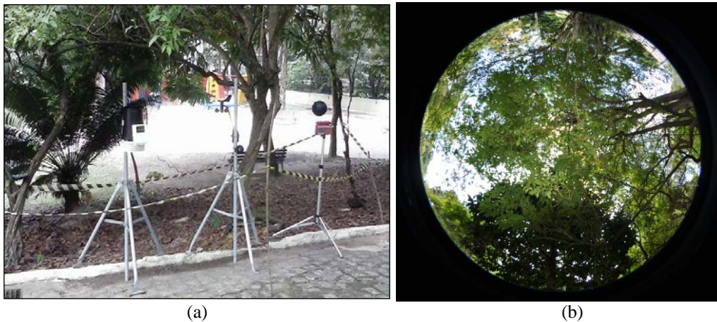
Figura 2 - Posto de medições das variáveis ambientais: visão lateral (a) e obstrução do céu (b)
