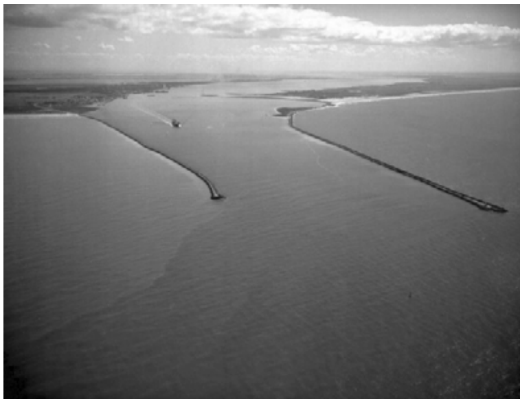
Fig. 2. Fluxo hidrossedimentar que chega ao oceano Atlântico pelo canal da barra do Rio Grande. É uma lâmina hídrica e sedimentar que se movimenta entre os molhes por cerca de 4 km, até ser lançada no oceano Atlântico. Imagem Google Earth.
