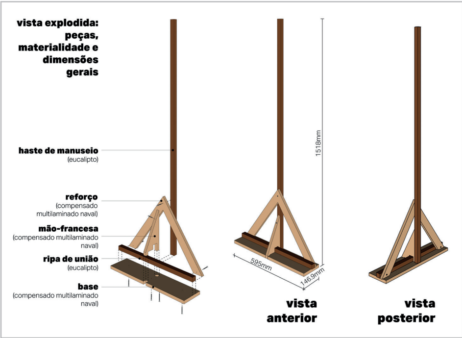
Figura 2 - Peças, materialidade, dimensões gerais e vista explodida do modelo final do rodo Fonte: Bárbara Lorenzo-ni (2024)
