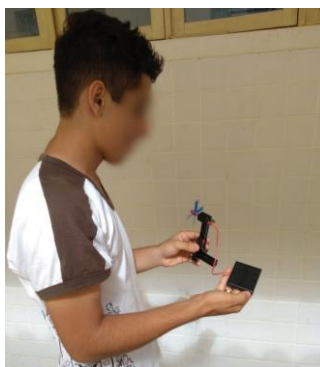
Figura 2 - Testes do ventilador movido a energia solar.
