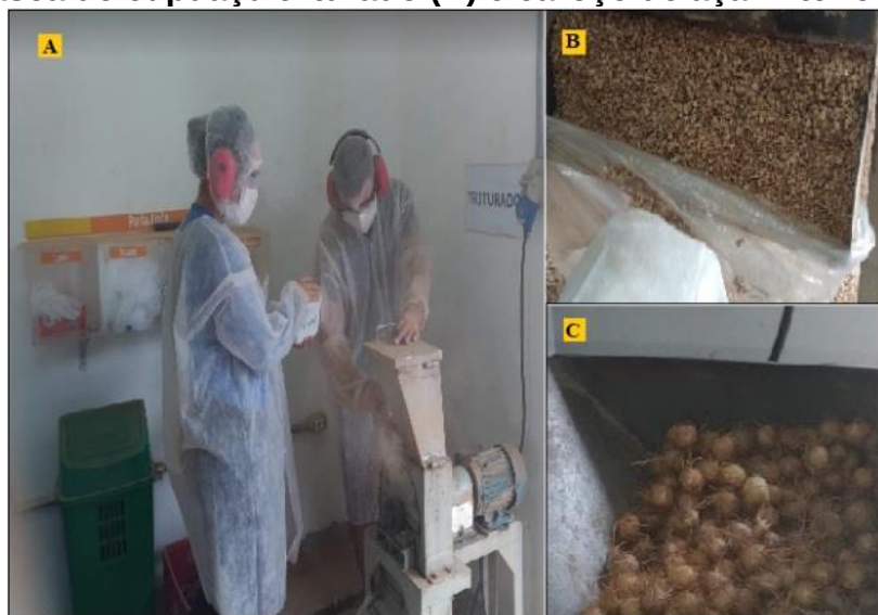
Figura 2- Trituração das biomassas após secagem: procedimento (A), Casca de cupuaçu triturado (B) e caroço de açaí inteiro (C)
