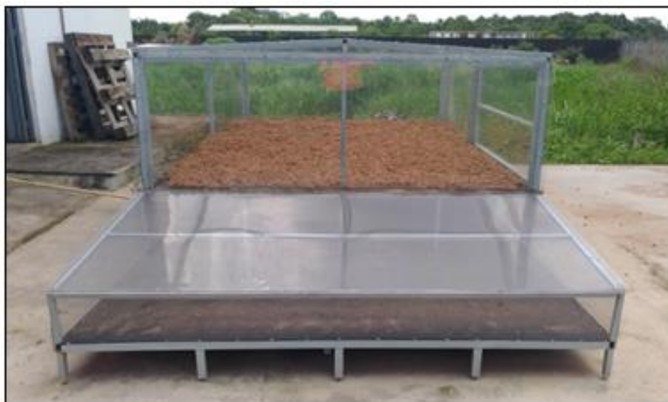
Figura 1- Secador solar usado na secagem dos resíduos
