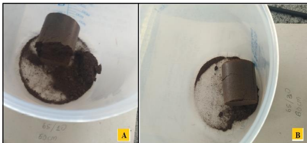
Figura 4- Teste de resistência ao impacto dos briquetes da casca de murumuru nas condições (granulometria, tempo de prensagem, altura da queda): 65mesh/20min./60cm (A) e 65mesh/30min./60cm (B)
