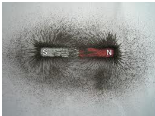
Figura 1: Representação do campo magnético de um ímã com limalha de ferro.
