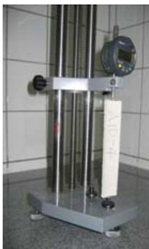
Figura 2 - Equipamento de avaliação da redução do comprimento dos corpos de prova
