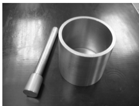
(b) Copo para determinação da densidade e do teor de ar incorporado
