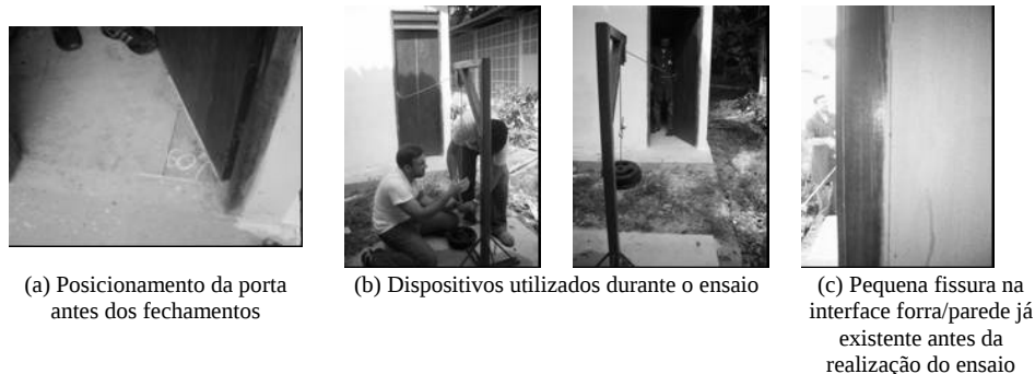
Figura 6 - Realização do ensaio de fechamento brusco de porta
