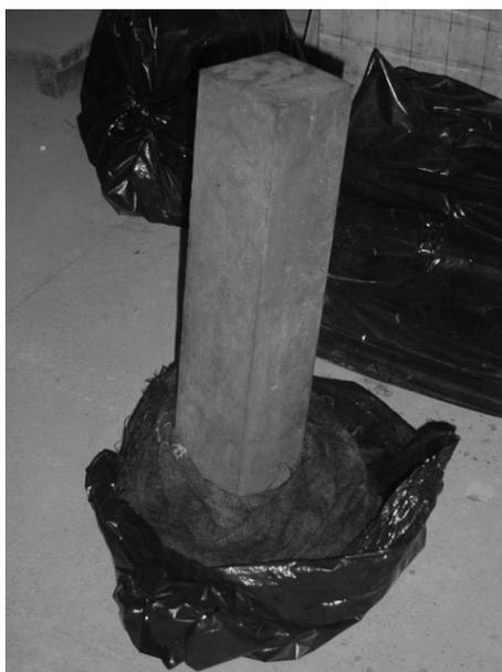
Figura 2 - Pilar sendo envolvido por saco de anagem úmido e saco plástico para cura
