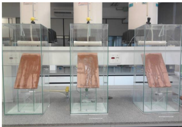
Figura 4 - Teste de lixiviação por irrigação em execução
