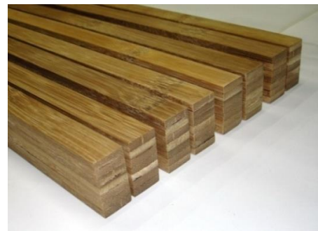
(b) Vigas acabadas (Cascorephen)
