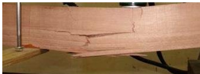
Figura 12 - Ruptura por tração nas vigas de madeira
