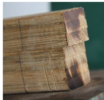
(b) Deslocamento horizontal relativo em plano de colagem, devido à ruptura por cisalhamento
