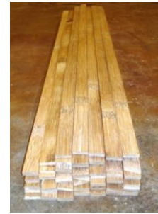
(c) Ripas de bambu após a usinagem
