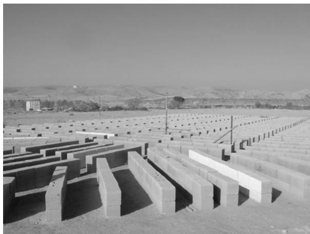
Figura 8 - O modelo reduzido (Open-Air Scaled Urban Surface - OASUS)
