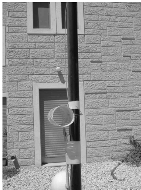
Figura 5 - Mastro com termopares cobre-constantan ultrafinos, protegidos contra radiação solar direta, posicionado ao centro do cânion
