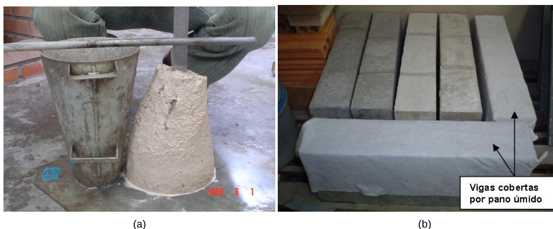
Figura 1 – (a) Determinação do abatimento de concreto de CP B através do ensaio de tronco de cone e (b) Cura das vigas em ambiente de laboratório
