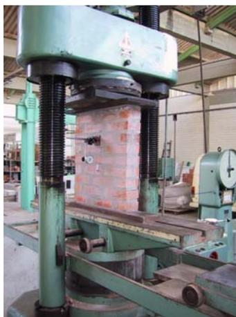
Figura 2 - Rompimento de miniparede no Laboratório de Materiais e Construção Civil da Universidade Federal de Santa Maria (UFSM)
