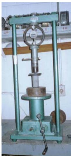
Figura 1 - Rompimento de corpo-de-prova de argamassa
