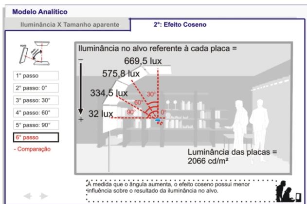
Figura 11 - Esquema do efeito cosseno
