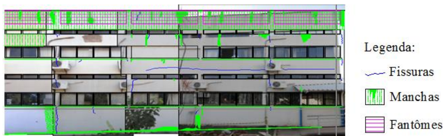
Figura 4 - Exemplo da confecção dos mapeamentos das manifestações patológicas da fachada sul do Bloco A
