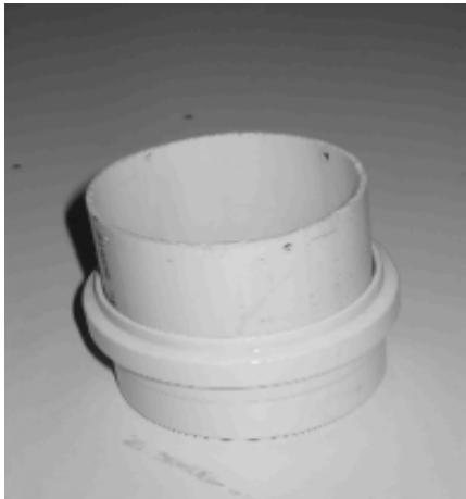
Figura 3 - Coletor de água cinza em caixa sifonada para a coleta das amostras
