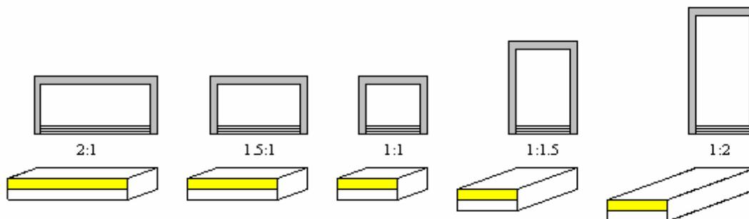
Figura 1 - Planta baixa e perspectiva das cinco geometrias de salas
