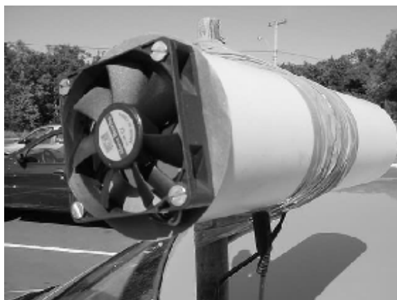
(a) Detalhe do tubo da proteção do termopar: em primeiro plano a ventoinha; por baixo, as entradas dos cabos de alimentação da ventoinha e do termopar
