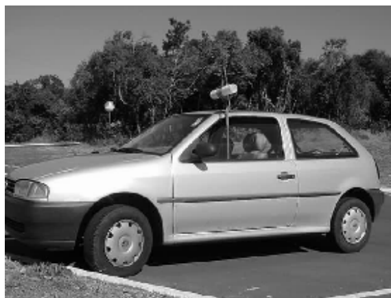
(b) Instalação do suporte do sensor no veículo
