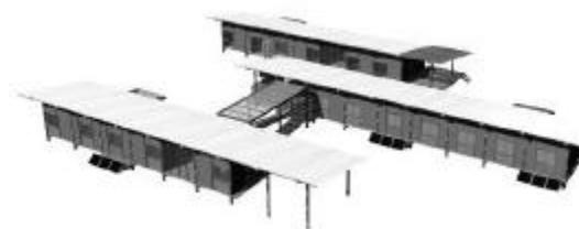
Figura 21 - Vista del conjunto edilicio desde en Noroeste, elevado sobre el nivel del terreno, instalaciones solares, expansiones con mosquiteros y circulaciones cubiertas que permiten fácil desplazamiento sin barreras, con gran importancia de los espacios intermedios
