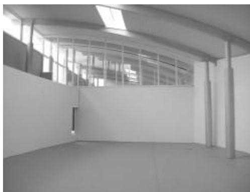
Figura 3 - Estudio de cantidad, distribución y calidad de iluminación natural en la Sala de Exposición, realizado con maqueta en el Cielo Artificial del CIHE
