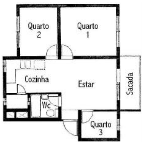
Figura 12 - Apartamento do tipo 1.0/300 oriundo da Coréia do Sul: um desenho compacto onde os quartos, se comunicam diretamente com a sala e a cozinha ao centro (CHOI, 1999, p. 69)
