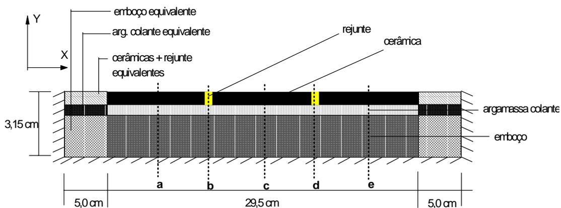
**Figura 4** - Modelo estudado - observa-se as condições de contorno e os pontos considerados nesta análise
