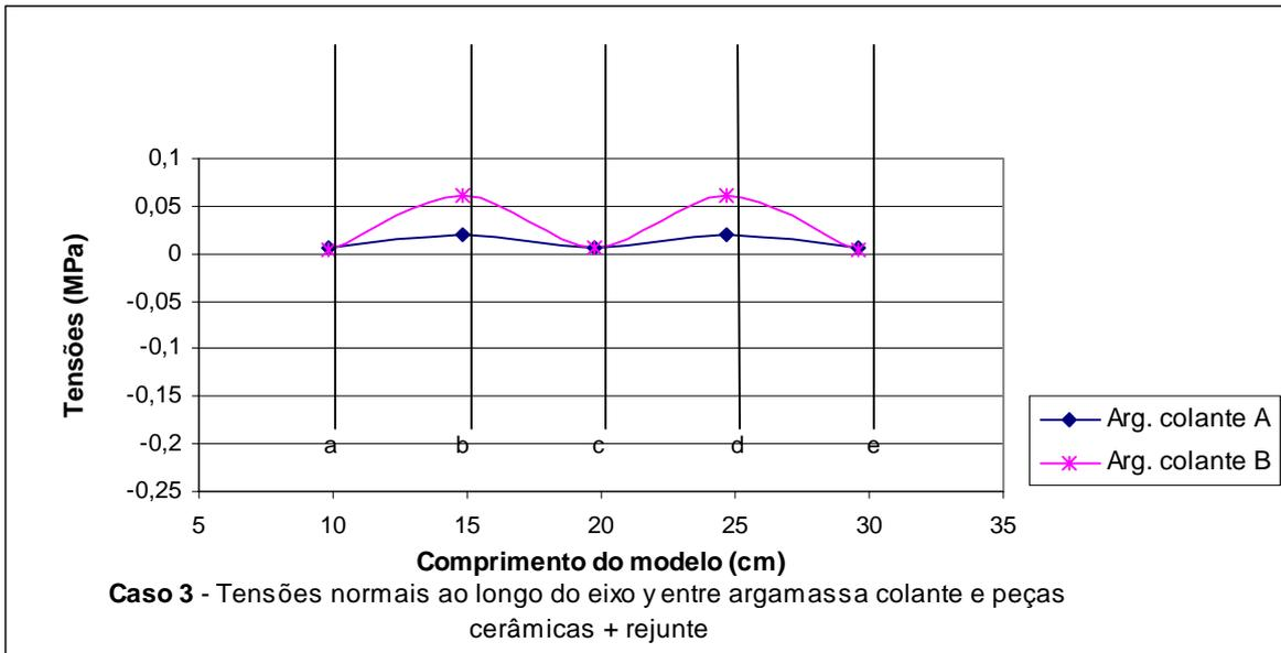
**Figura 7**- Níveis de tensões normais ao longo do eixo Y entre a camada de argamassa colante e peças cerâmicas do sistema de revestimento para o caso 3 (emboço com 50 mm, coeficiente de absorção térmica da cerâmica baixo e rejunte tipo 1)
