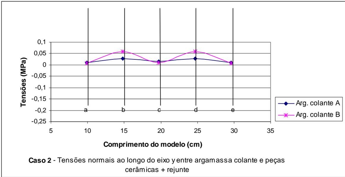
**Figura 6** - Níveis de tensões normais ao longo do eixo Y entre a camada de argamassa colante e peças cerâmicas do sistema de revestimento para o caso 2 (emboço com 10 mm, coeficiente de absorção térmica da cerâmica baixo e rejunte tipo 1)
