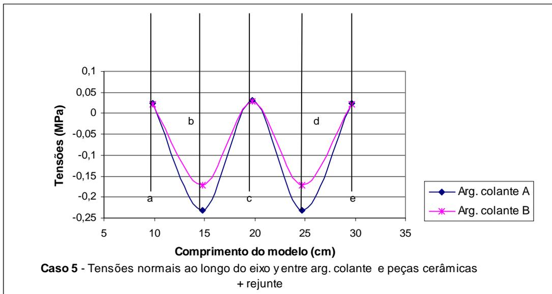
**Figura 10** - Níveis de tensões normais ao longo do eixo Y entre a camada de argamassa colante e peças cerâmicas do sistema de revestimento para o caso 5 (emboço com 20 mm, coeficiente de absorção térmica da cerâmica baixo e rejunte tipo 2)
