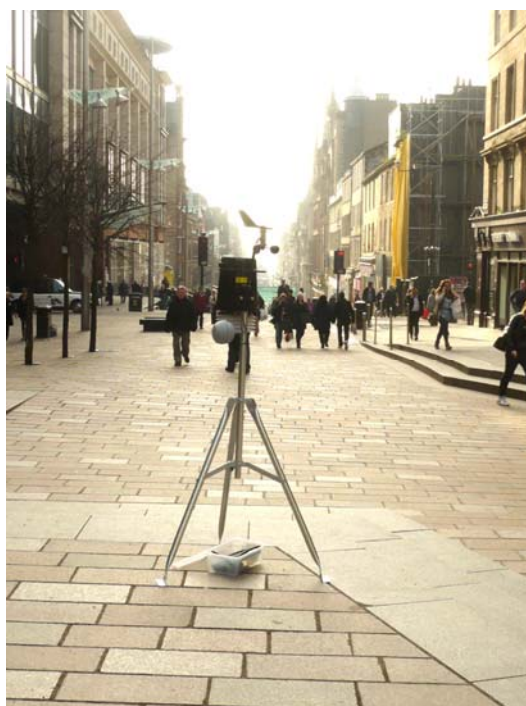
Figura 2 - Estação meteorológica Davis Vantage Pro2 com termômetro de globo cinza, no ponto CS-1
