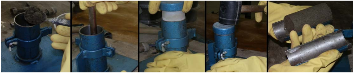
Figura 2 - Sequência de etapas para moldagem dos corpos de prova
