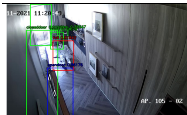
Figura 2 – Sistema de monitoramento e detecção de quedas em funcionamento.
