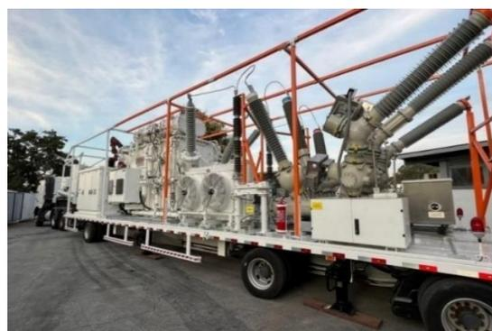
Figura 4 – Subestação Móvel
