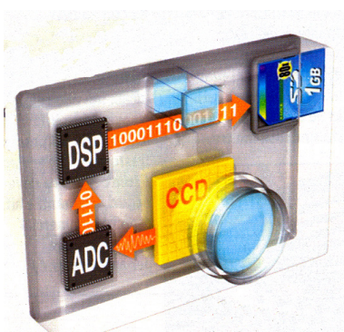
FIG. 01: Interior de uma câmera digital. Fonte: acervo do autor.
