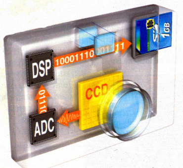
FIG. 01: Interior de uma câmera digital. Fonte: acervo do autor.
