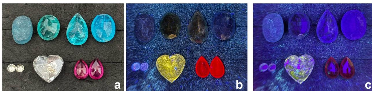
Figura 10. Efeito da luz UV sobre amostras de apatita tratada e não tratada e em diamantes e rubis como comparação. A) Parte superior, amostras de apatita, da esquerda para direita, não tratada, aquecida a 600, 650 e 700°C; abaixo, à esquerda e centro, diamantes e rubis à direita. B) Amostras sob luz UV de ondas curtas (255 nm). C) Amostras sob luz UV de ondas longas (365 nm).
