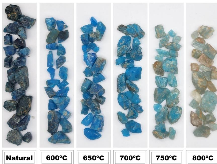
Figura 4. Comparação entre as amostras brutas de apatita sem aquecimento e após o aquecimento em diferentes temperaturas
