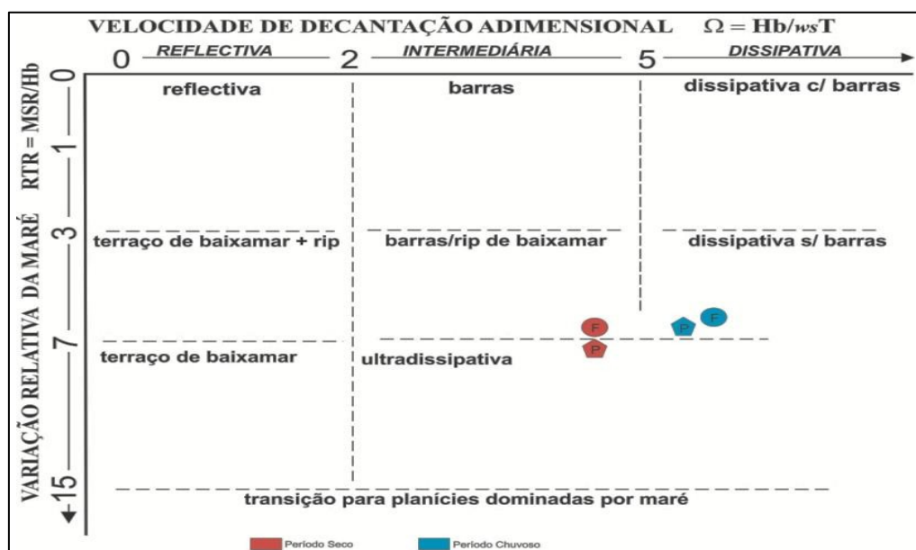
Figura 9. Estados morfodinâmicos das praias da Princesa (losango) e Fortalezinha (círculo), utilizando o modelo conceitual de praia, onde o estado da praia é função da relação entre o parâmetro \Omega e o RTR.
