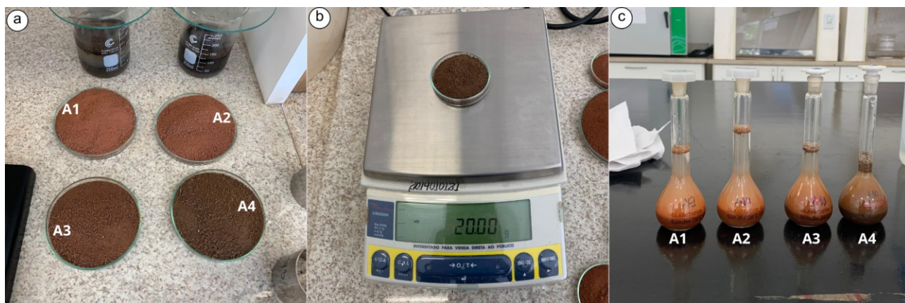
Figura 5. Processo de análise das amostras no laboratório: a) desagregação, peneiramento e separação, b) pesagem, c) diluição (Autor, 2023).
