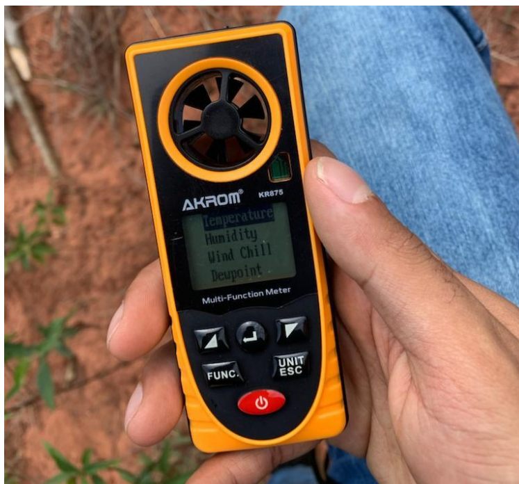
Figura 4. Medidor multiparâmetro utilizado em campo (Autor, 2023).
