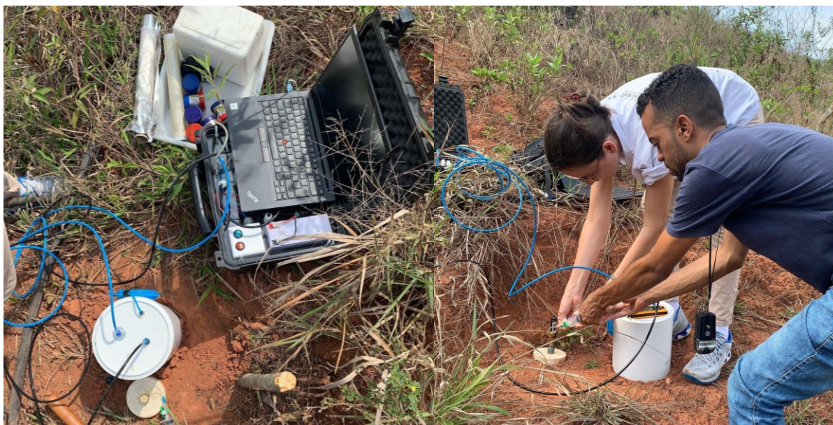
Figura 6. Analisador de gás por infravermelho com câmara dinâmica (Autor, 2023).
