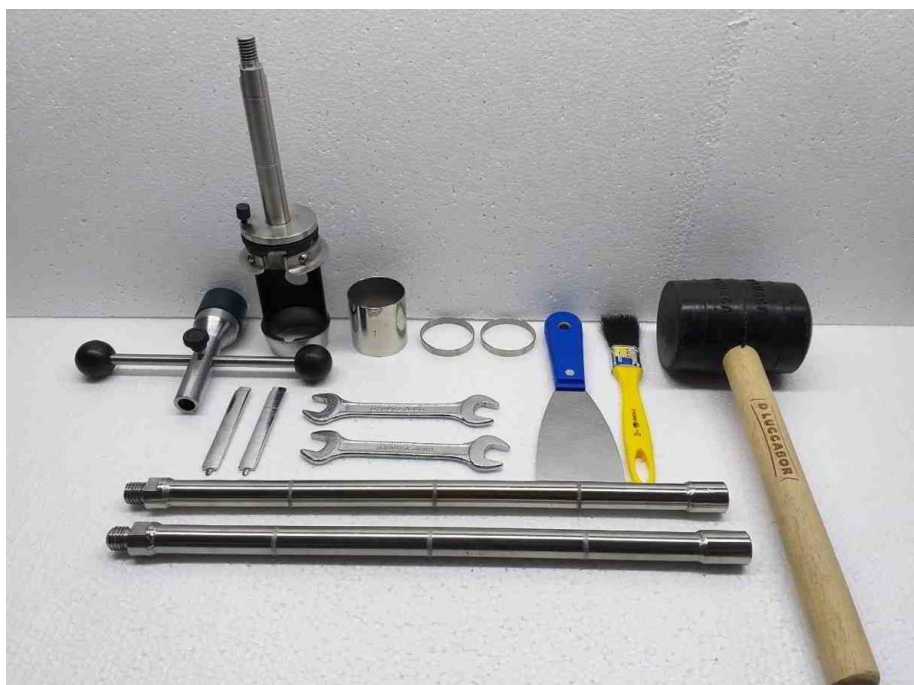
Figura 2. Trado para amostras indeformadas e demais materiais utilizados (SoilControl.com).
