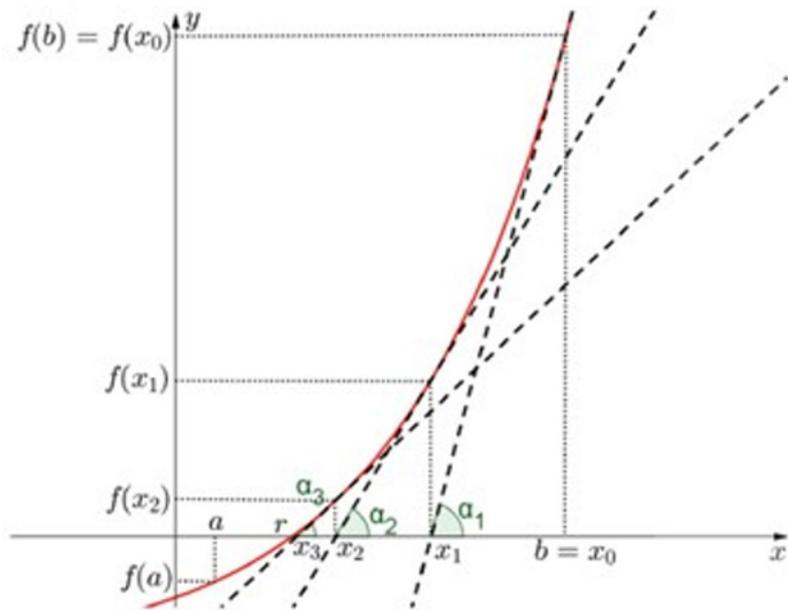
Figura 2. Representação gráfica do método de Newton-Raphson
