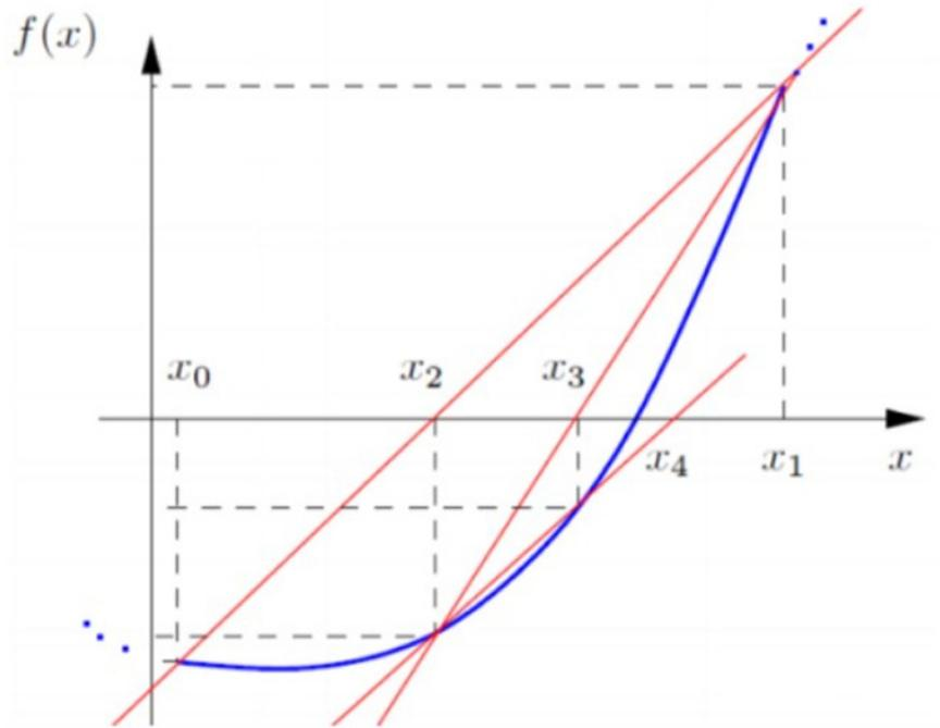
Figura 3. Representação gráfica do método da Secante
