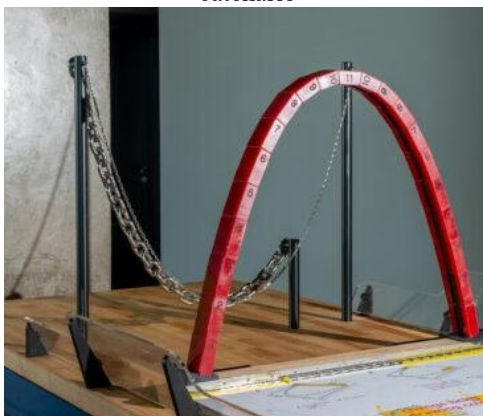
Figura 4 - Exemplos dos módulos expositivos que compõem a galeria Aprender Fazendo: Arco catenário
