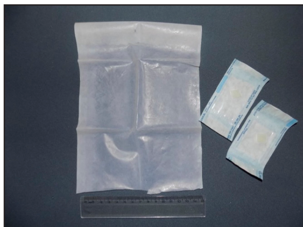
Figura 1. Membrana de PBAT/TPS: folha íntegra (à esquerda) e recortada em fragmentos de 1cm 2 , embaladas individualmente e esterilizadas com radiação gama, na faixa de 10 a 30 Gy (à direita).
