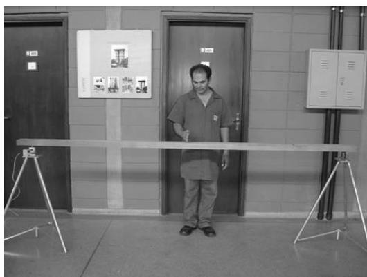
Figura 3 - Ensaio de vibração transversal
