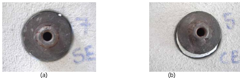
Figura 5 - Colagem das pastilhas sobre os corpos de prova (a) sem excentricidade (b) com excentricidade
