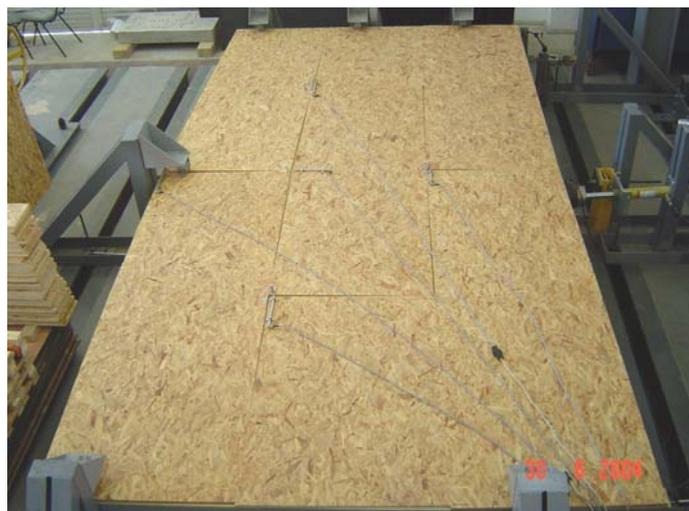
Figura 17 - Deslocamentos das chapas de fechamento observado ao término do ensaio de flexão
