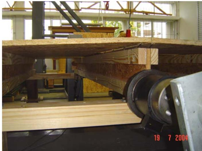
Figura 15 - Arrancamento dos pregos lisos, observado ao término do ensaio de flexão
