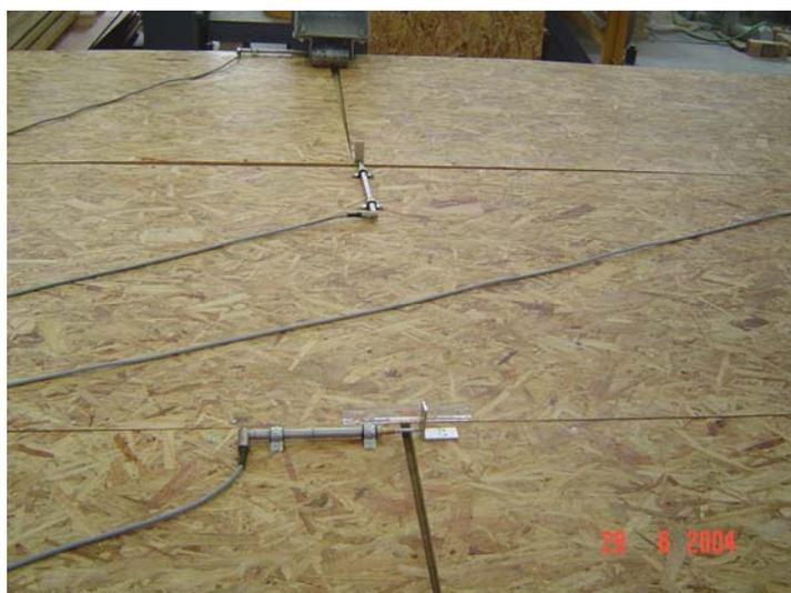
Figura 16 - Deslocamentos das chapas de fechamento observado ao término do ensaio de flexão
