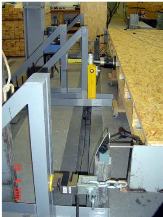
Figura 8 - Disposição das células de carga nos diafragmas horizontais de piso
