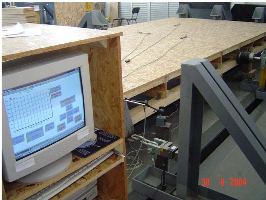
Figura 9 - Sistema de aquisição de dados empregado no ensaio dos protótipos
