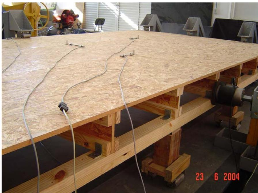
Figura 10 - Disposição dos transdutores de deslocamento nos protótipos
