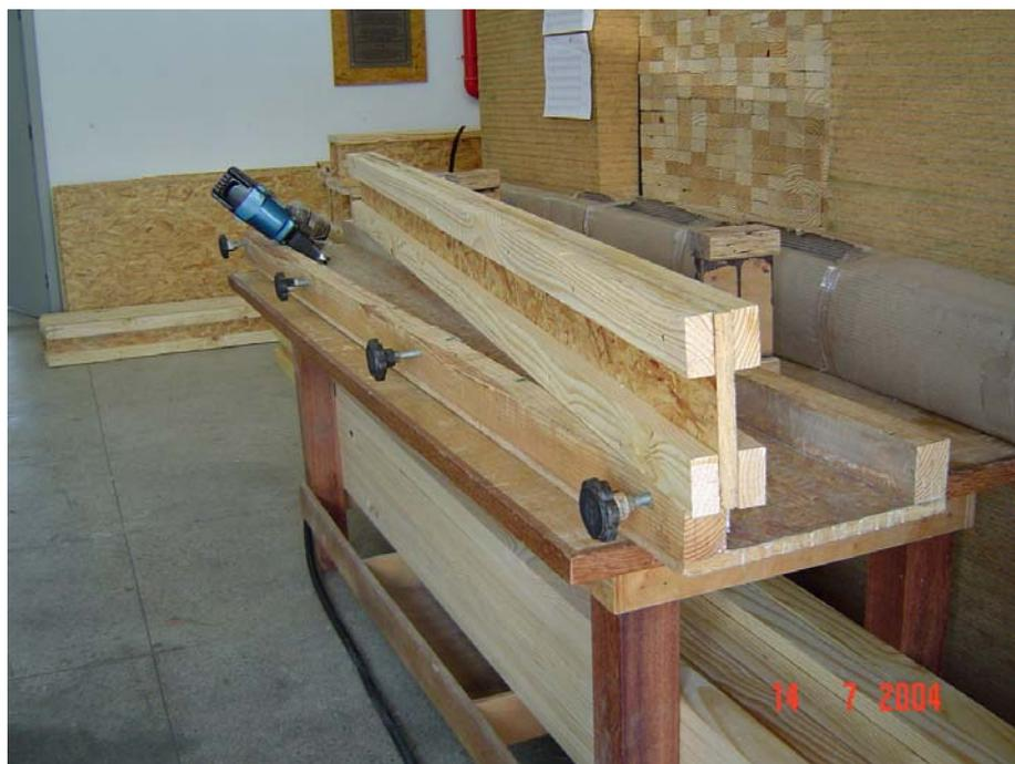
Figura 3 - Confeção das vigas-I empregadas como elementos de ossatura
