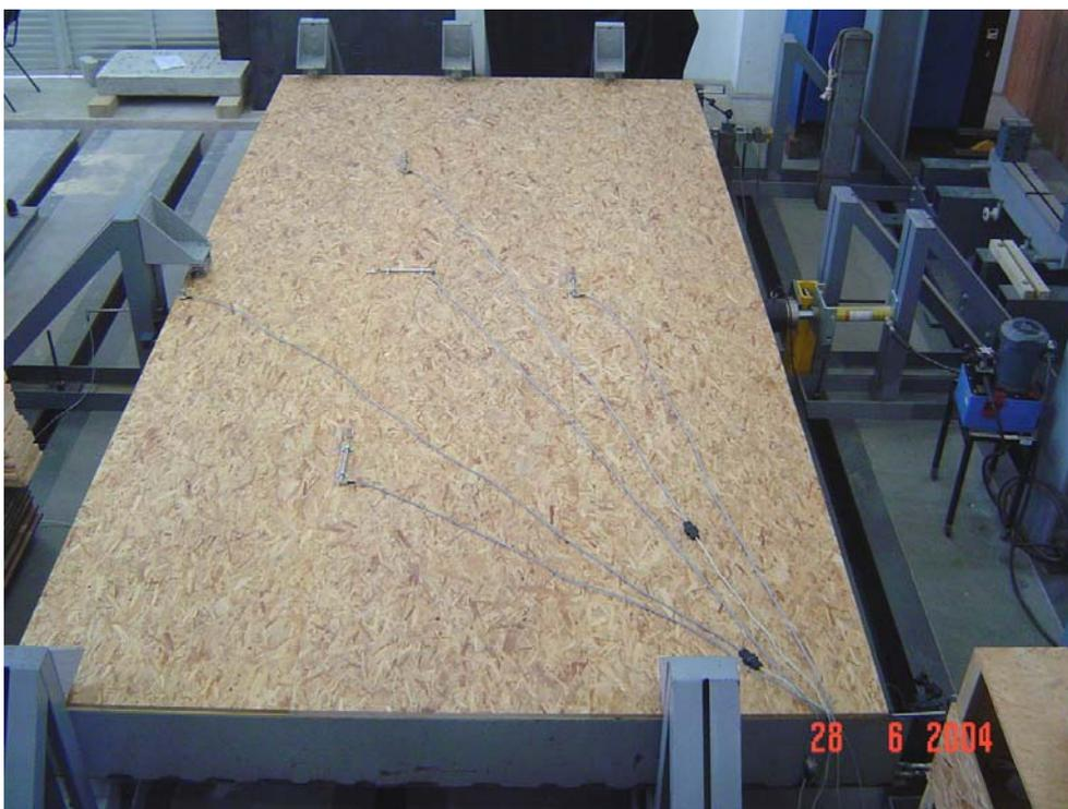
Figura 6 - Estrutura de contenção dos diafragmas horizontais de piso
