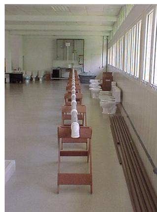
Figura 2 - Ramal para o teste de transporte de sólidos - CTCC/EP-USP (OLIVEIRA JÚNIOR, 2002)
