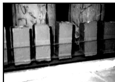
Figura 3 - Corpos de prova de 40 mm x 40 mm x 80 mm imersos em água
