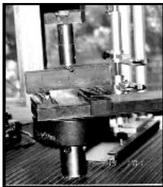
Figura 2 - Ensaio de tração na flexão em corpos de prova de 40mm x 40mm x 160mm
