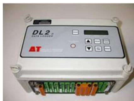
Figura 7 - Sistema de aquisição de dados DL2-DeltaT
