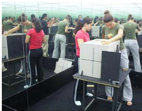
Figura 12 - Estudo em desenvolvimento no céu artificial do tipo "caixa de espelhos" do LabCon/ARO
